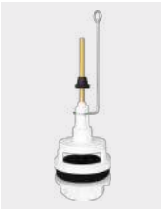
DESCARGADOR DC 261 Ref. 0156004810 Packaging Bolsa 25 uds/caja PVP: 3,94 € Ø 5 mm + Longitud: 165 mm (Latón) Base: PS/SBR (Plástico)
